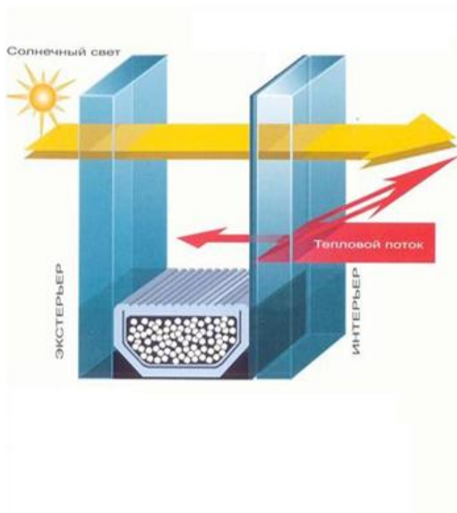
Тепловой поток через многослойную стенку стеклопакета
