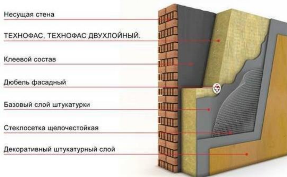
Изоляция штукатурного фасада.
