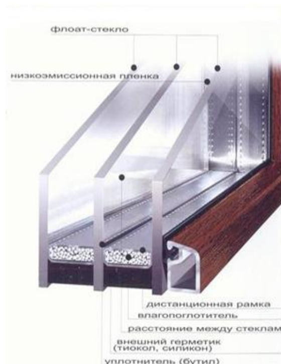
Конструкция стеклопакета
