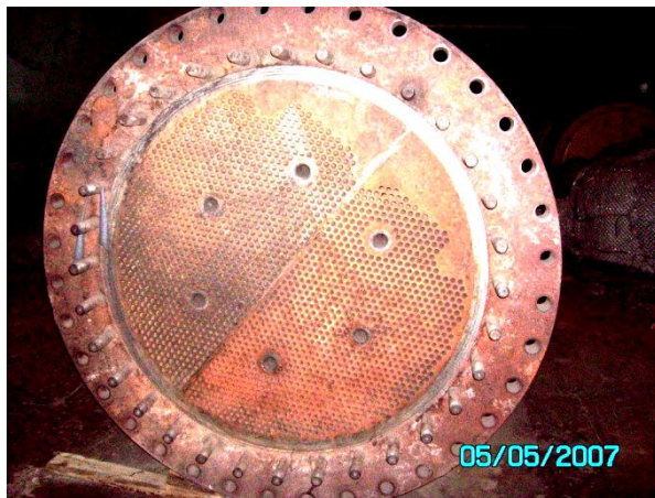
Торец кожухотрубчатого теплообменника
